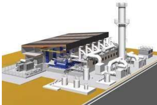
天然ガスコジェネ発電所 (ガスエンジン 32MW)
