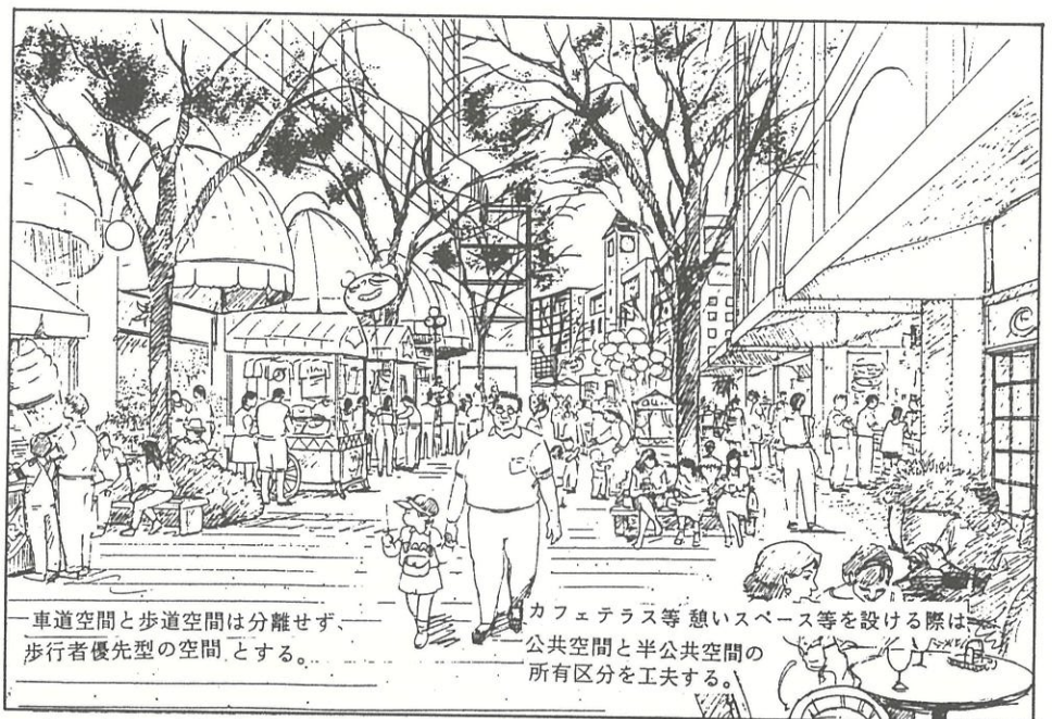
8m幅の歩行者優先路+セットバック空間(3+3m)の場合のデザイン
